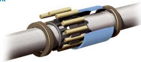
**Les vis à rouleaux satellites RVR** présentent des pas très fins et sont utilisées lorsqu'on a besoin d'une très grande précision de positionnement associée à une grande rigidité et à une capacité de charge élevée. Les principaux éléments des vis à rouleaux satellites RVR sont la vis, l'écrou et les rouleaux qui sont guidés et maintenus à distance dans une cage.
